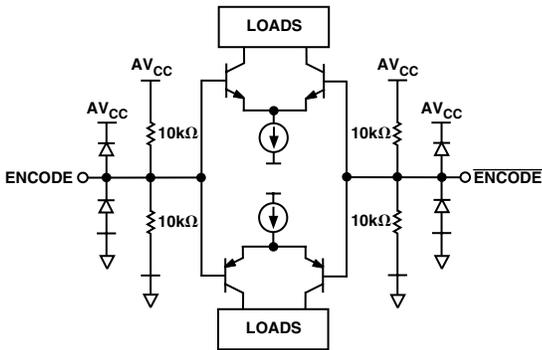
Figure 3. ENCODE Inputs
