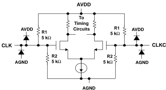
Figure 28. Clock Inputs
