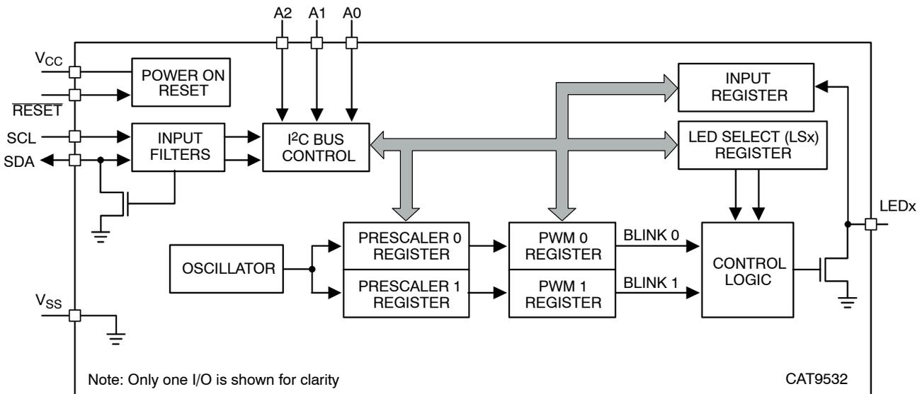
**Figure 3. Block Diagram**
