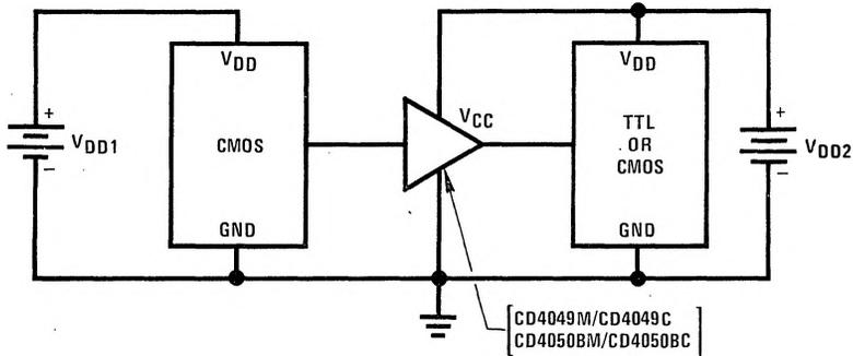
Note:  $V_{DD1} \geq V_{DD2}$
