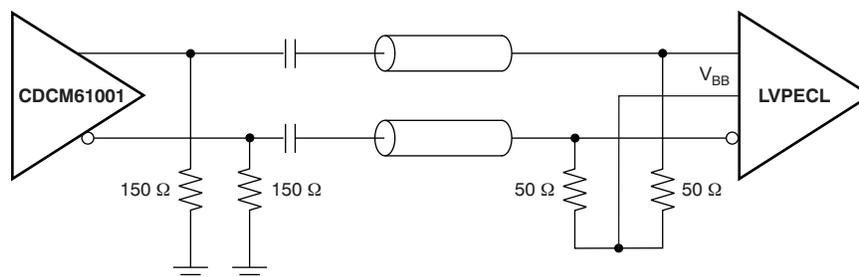
**Figure 21. LVPECL Output AC Termination**
