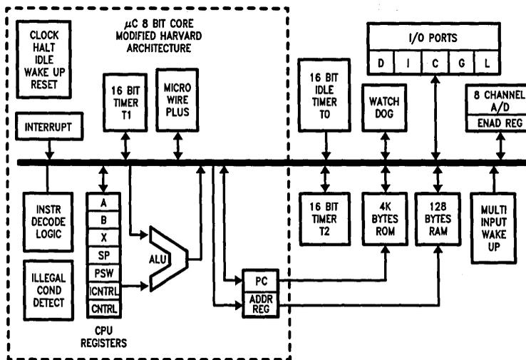
FIGURE 1. COP888CF Block Diagram
