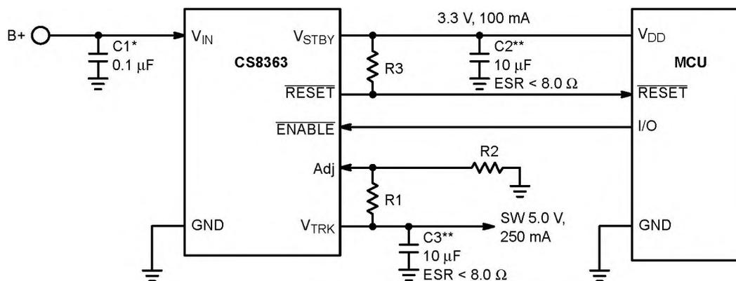
$$V_{TRK} = V_{STBY}(1 + R1/R2)$$
