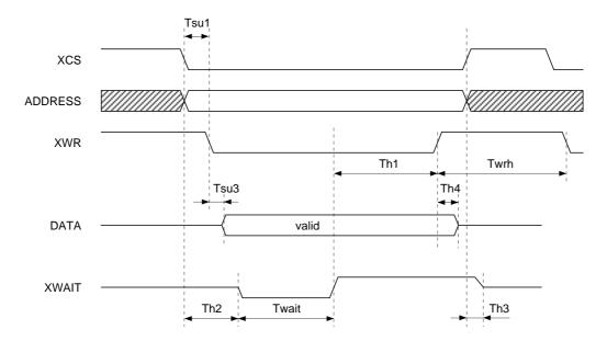
Tsu1 5nsec min, Tsu3 13nsec max, Th1 5nsec min, Twrh 60nsec min Twait 100nsec max, Th2 8nsec max, Th3 14nsec max, Th4 5nsec min
