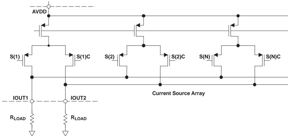
**Figure 19. Analog Outputs**
