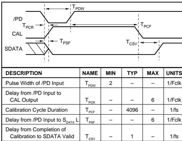
FIGURE 3b. DF1760 Power Down and Offset Calibration.
