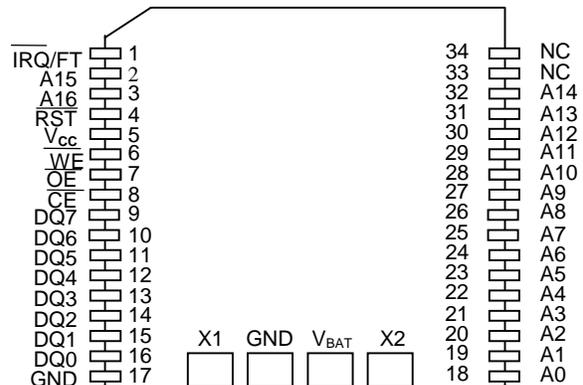
34-Pin PowerCap<sup>®</sup> Module Board
