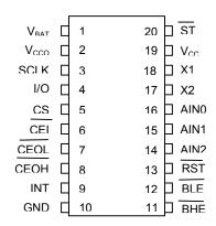
20-Pin TSSOP (4.4mm) 20-Pin SOIC (300 mil)
