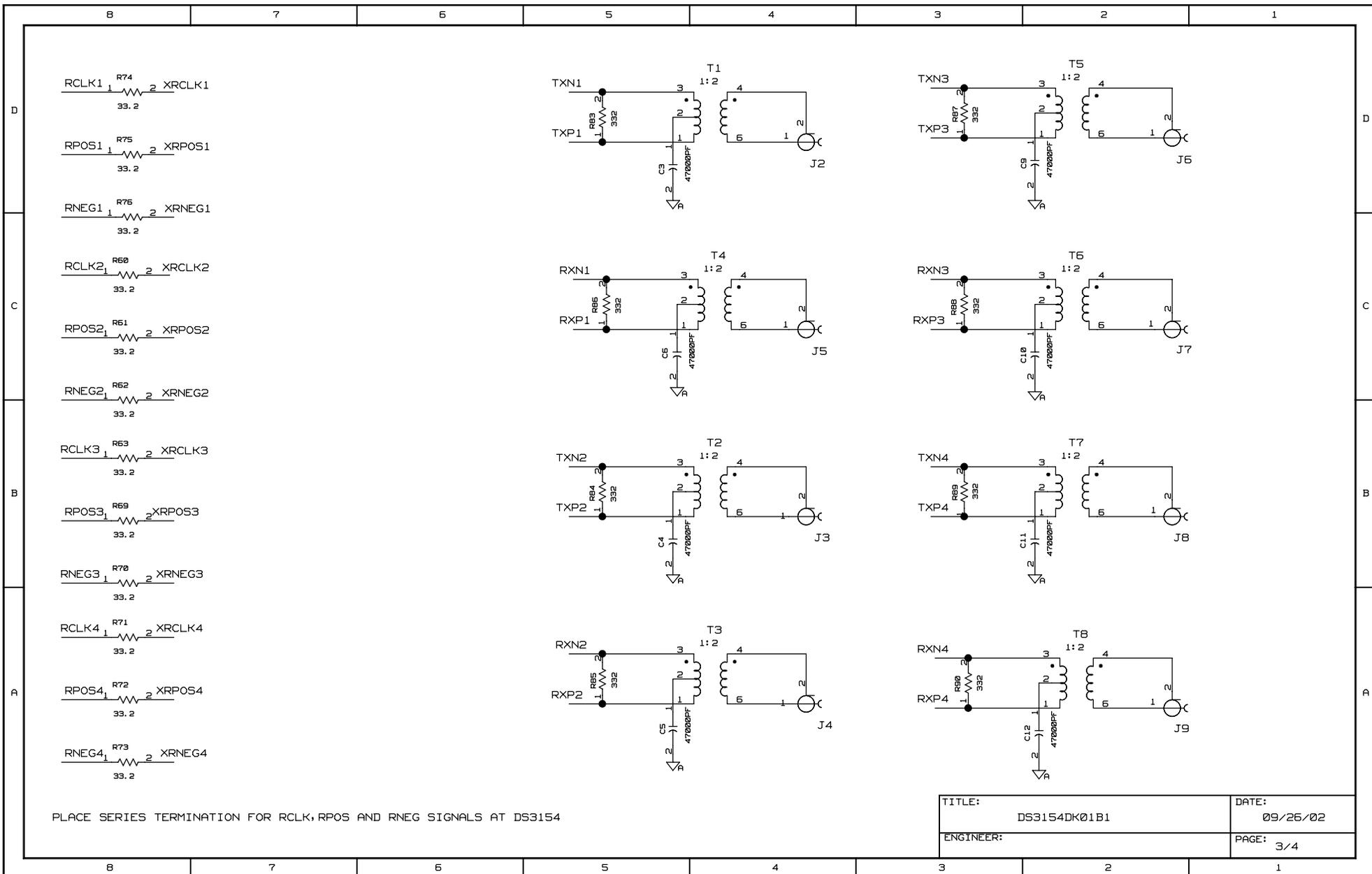
PLACE SERIES TERMINATION FOR RCLK, RPOS AND RNEG SIGNALS AT DS3154
