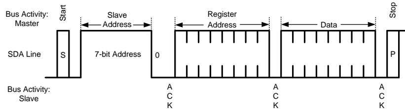
Figure 24. Write Byte
