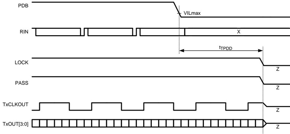
Figure 5. FPD-Link & LVCMOS Powerdown Delay
