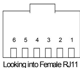
**Figure 5. iBUTTON SOCKET FOR DS9490B**
