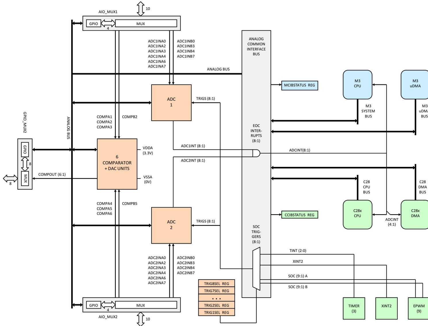
Figure 2-3. Analog Subsystem
