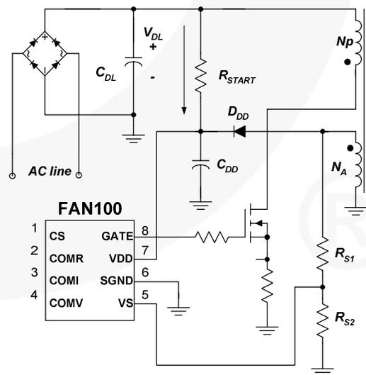
Figure 27. Startup Circuit
