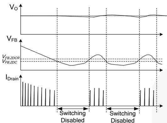
**Figure 26. Burst-Mode Operation**
