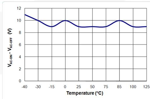
Figure 11. V<sub>AC-ON</sub> - V<sub>AC-OFF</sub> vs. Temperature
