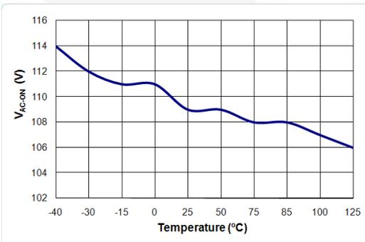
Figure 10. V<sub>AC-ON</sub> vs. Temperature
