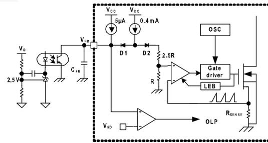
Figure 16. Pulse-Width-Modulation Circuit
