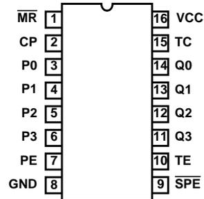
16 LEAD CERAMIC METAL SEAL FLATPACK PACKAGE (FLATPACK)
