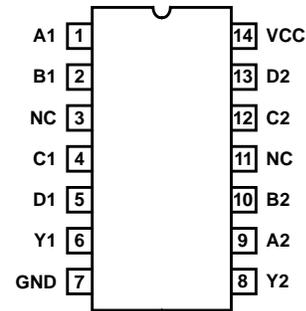
14 LEAD CERAMIC METAL SEAL FLATPACK PACKAGE
