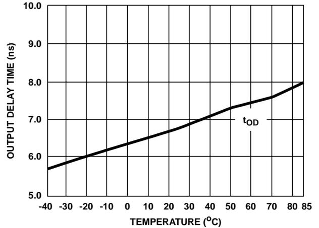
FIGURE 8. OUTPUT DELAY TIME ( $T_{OD}$ ) vs TEMPERATURE
