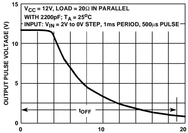
FIGURE 3B. OUTPUT TURN-OFF TIME ( $\mu s$ )
