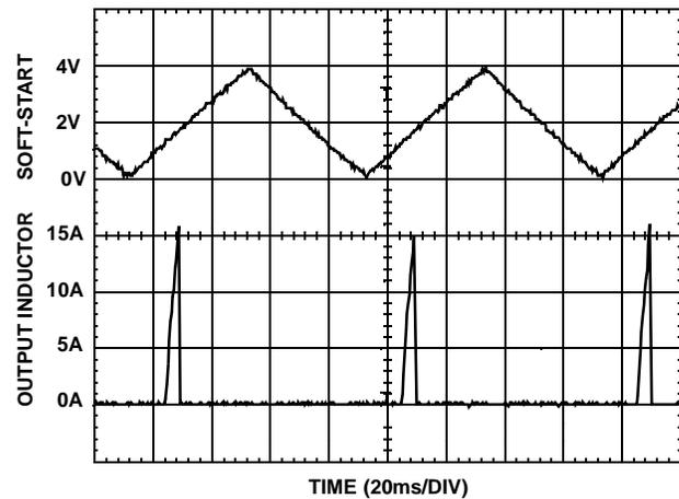
FIGURE 4. OVER-CURRENT OPERATION
