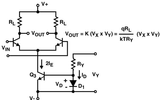
**FIGURE 2. TRANSCONDUCTANCE MULTIPLIER**
