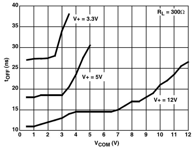
FIGURE 14. TURN - OFF TIME vs SWITCH VOLTAGE
