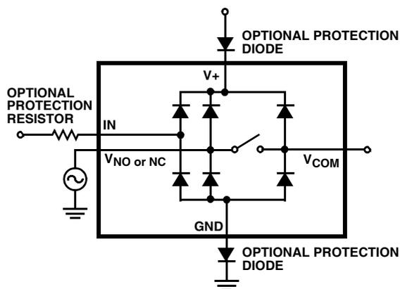
FIGURE 6. OVERVOLTAGE PROTECTION
