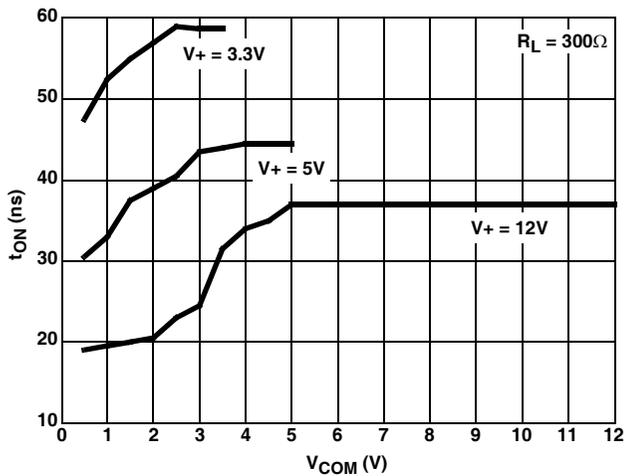
FIGURE 13. TURN - ON TIME vs SWITCH VOLTAGE
