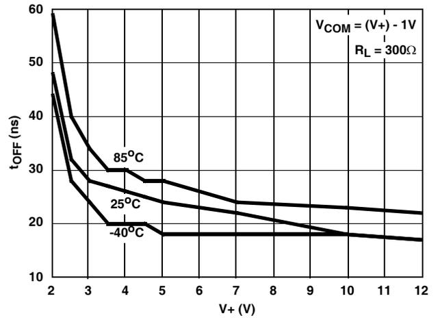
FIGURE 12. TURN - OFF TIME vs SUPPLY VOLTAGE
