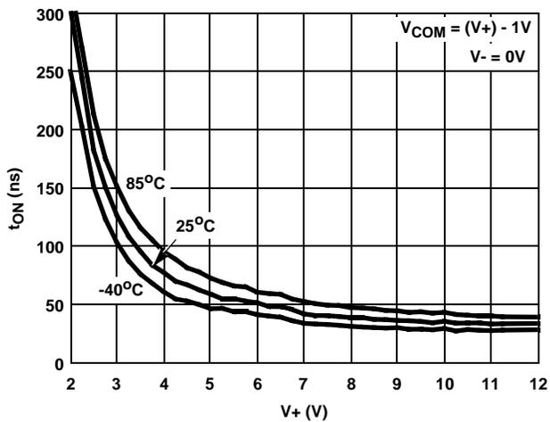
FIGURE 13. TURN - ON TIME vs POSITIVE SUPPLY VOLTAGE
