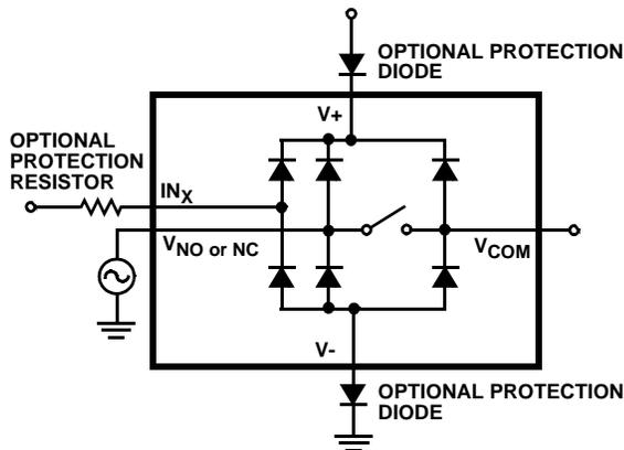
FIGURE 8. OVERVOLTAGE PROTECTION
