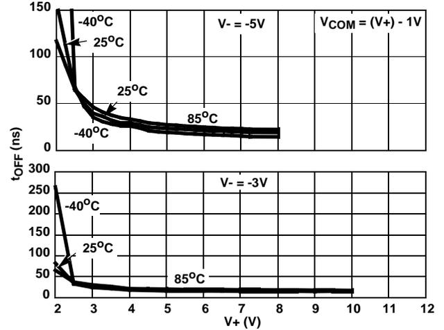
FIGURE 16. TURN - OFF TIME vs POSITIVE SUPPLY VOLTAGE
