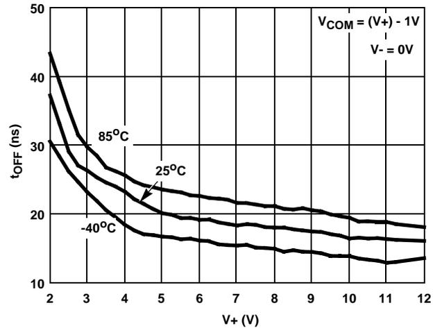
FIGURE 14. TURN - OFF TIME vs POSITIVE SUPPLY VOLTAGE
