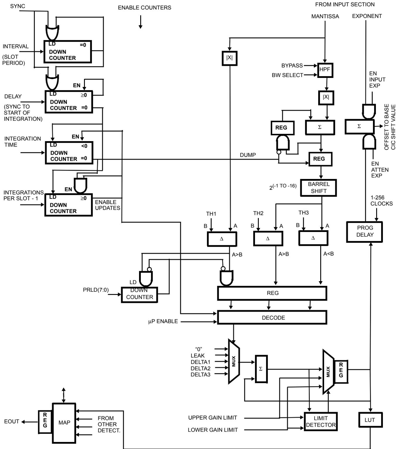
FIGURE 2. RANGE CONTROL BLOCK DIAGRAM
