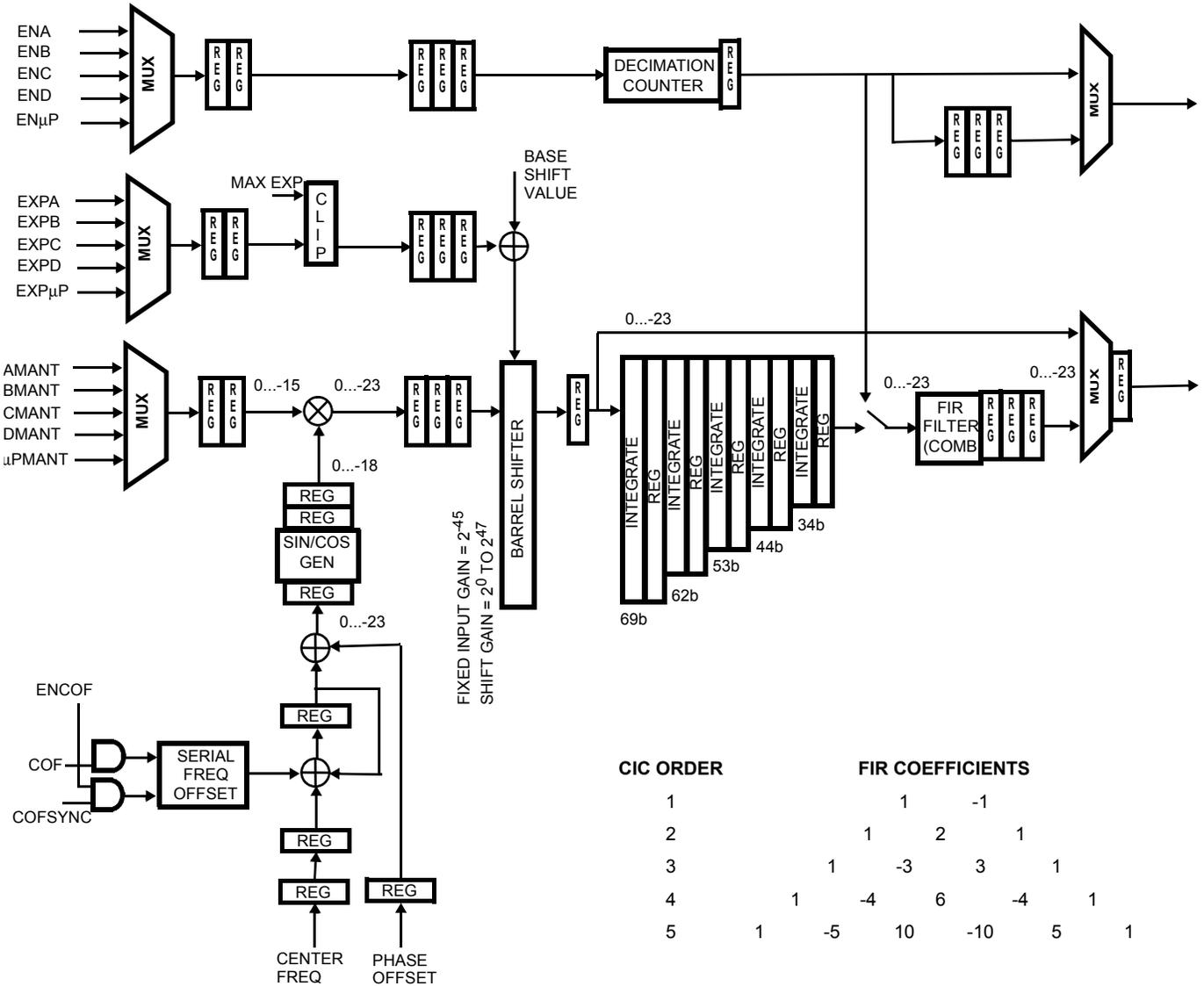
FIGURE 3. NCO, MIXER AND CIC BLOCK DIAGRAM
