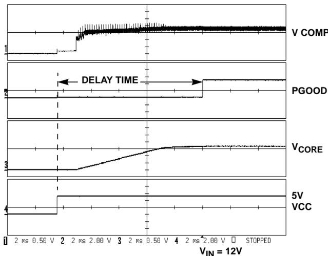
FIGURE 4. START-UP OF 4 PHASE SYSTEM OPERATING AT 200kHz
