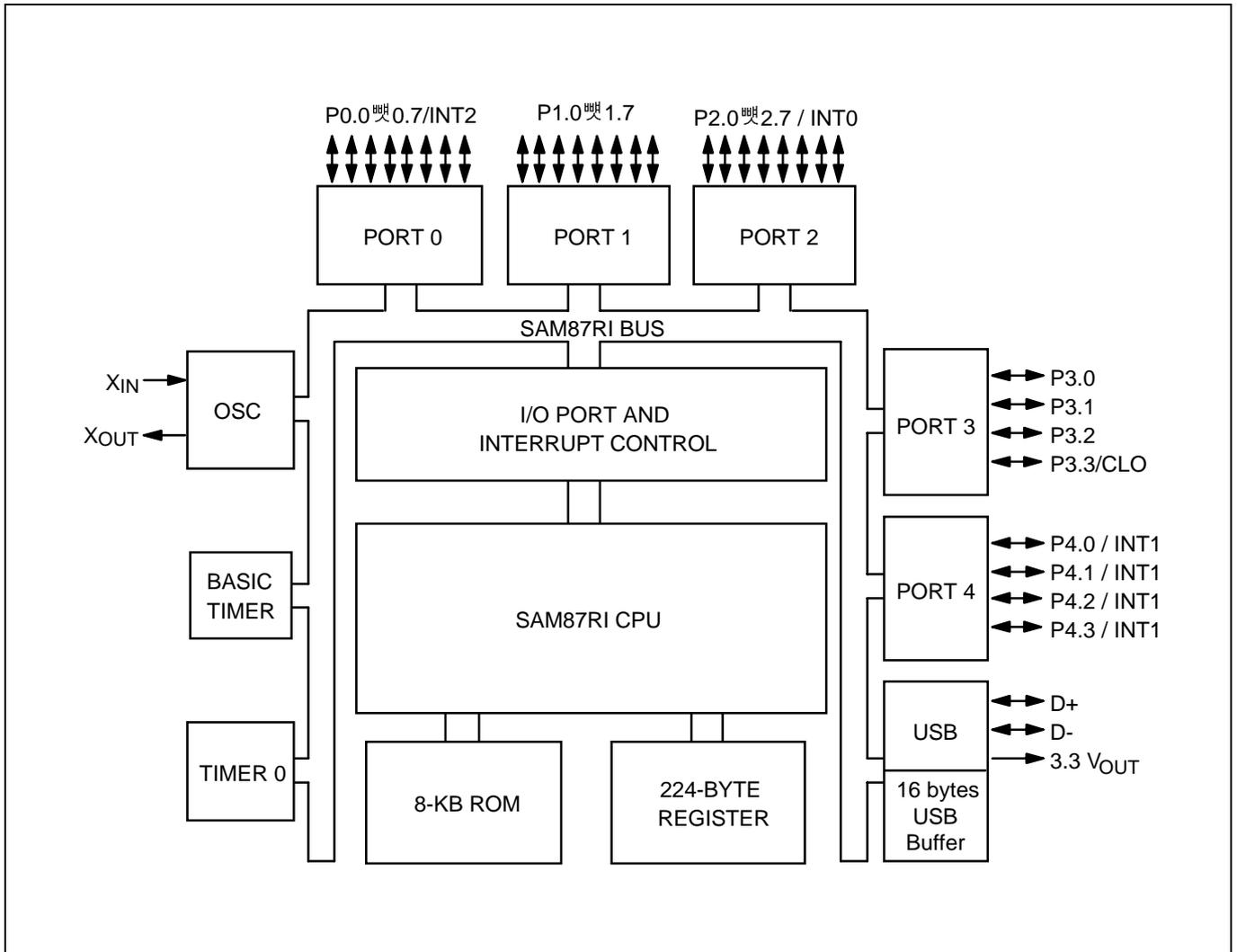
**Figure 1-1. Block Diagram**
