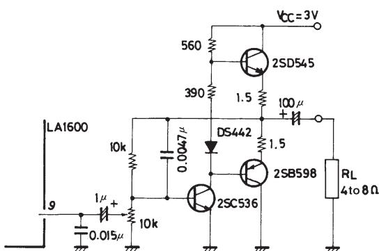
Unit (resistance : Ω, capacitance : F)
