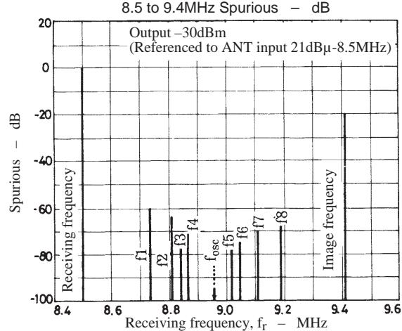
$f_1 : 8.7336\text{MHz} \rightarrow 2f_{osc}-2f_1 = 455\text{kHz}$
