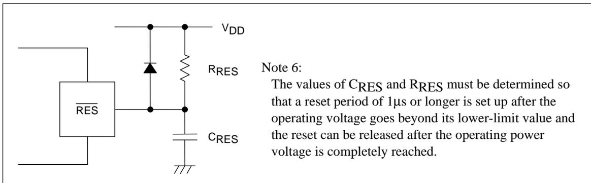
Fig. 8: Reset Circuit
