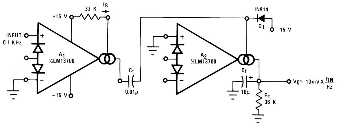
FIGURE 23. Tachometer
