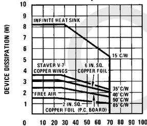
$T_A$  - AMBIENT TEMPERATURE ( $^\circ\text{C}$ )
