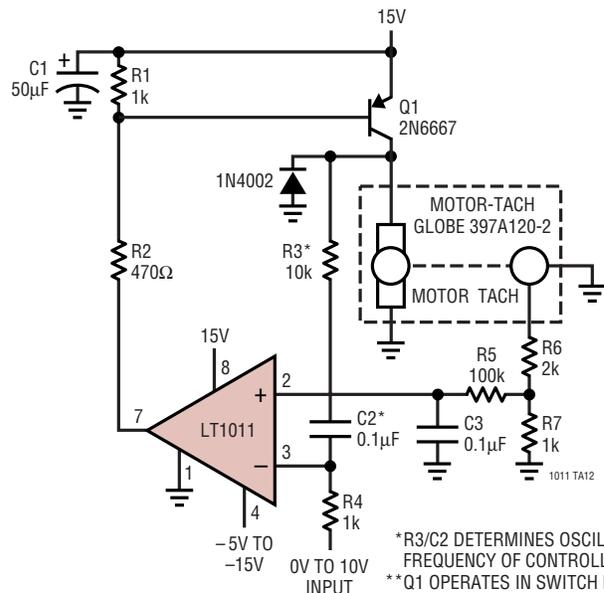
\*R3/C2 DETERMINES OSCILLATION FREQUENCY OF CONTROLLER
