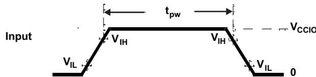
**Figure 3-2. TTL-Level Inputs**
