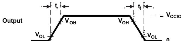
**Figure 3-3. CMOS-Level Outputs**
