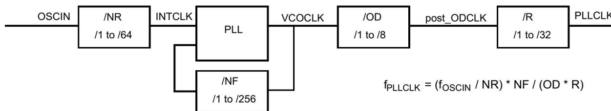
Figure 4-6. PLL Block Diagram
