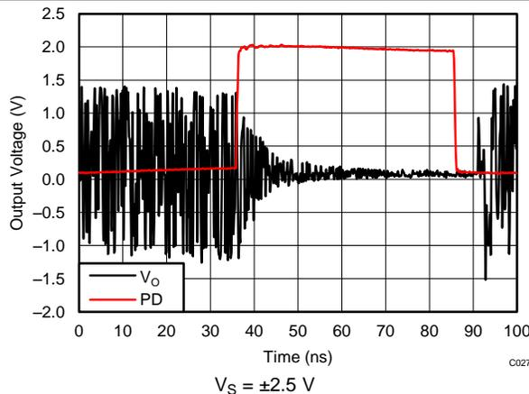
Figure 27. Power-Down Timing
