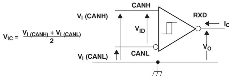
$$V_{IC} = \frac{V_{I(CANH)} + V_{I(CANL)}}{2}$$
