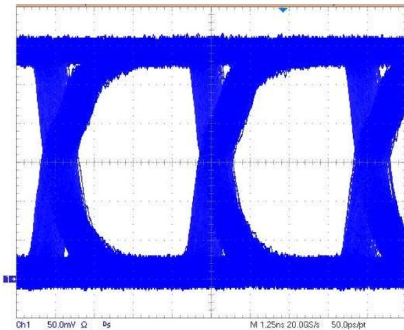
Figure 12. SN65LVDS348 Eye Pattern Running at 200 Mxfr/s
