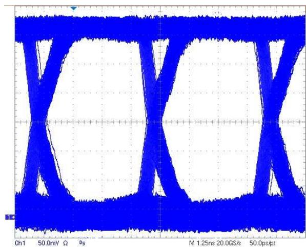
Figure 13. SN65LVDS352 Eye Pattern Running at 200 Mxfr/s
