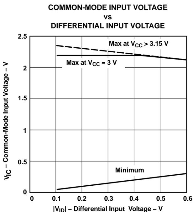
Figure 1. V<sub>IC</sub> vs V<sub>ID</sub> and V<sub>CC</sub>
