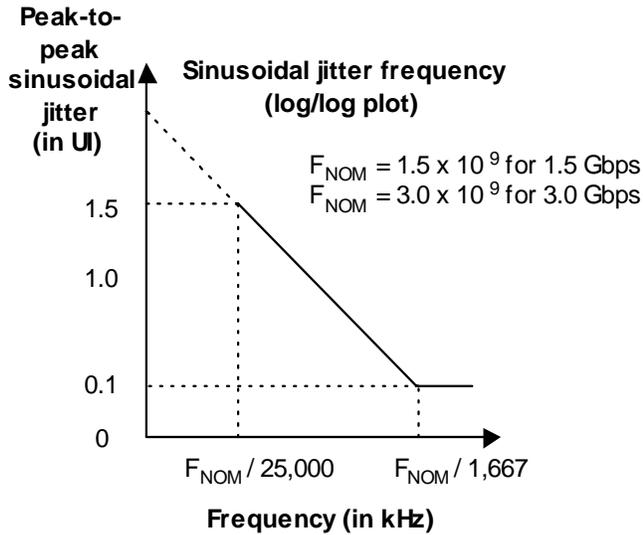
Figure 20. Sinusoidal jitter mask
