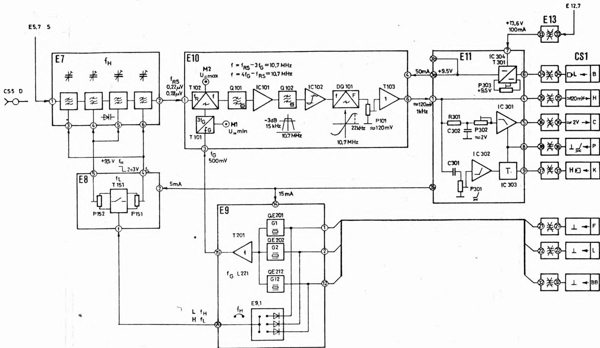
Функциональная схема приемника FM 300
