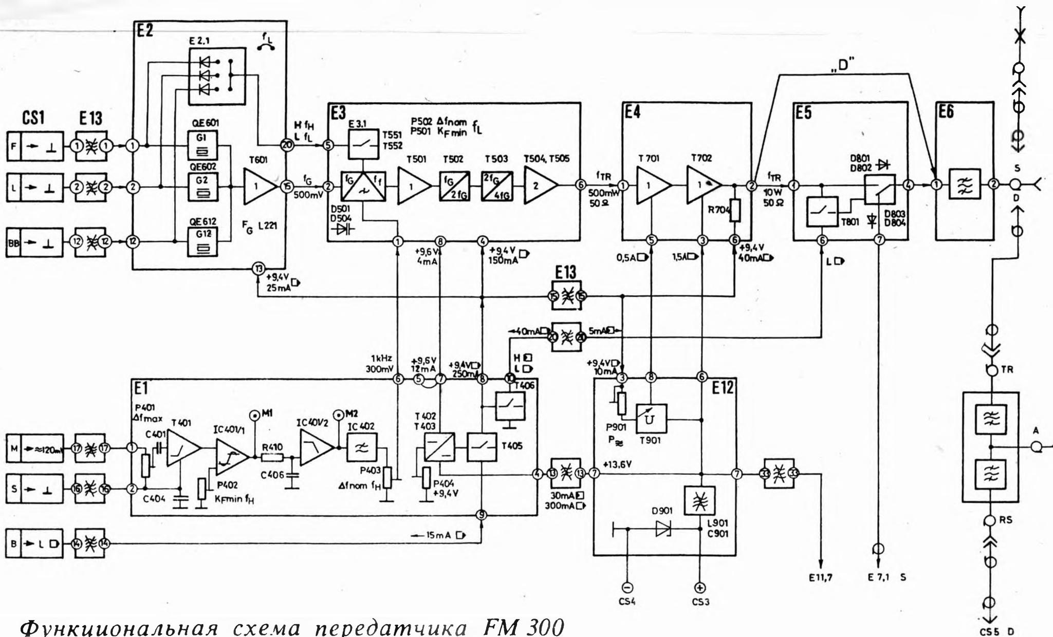
Функциональная схема передатчика FM 300
