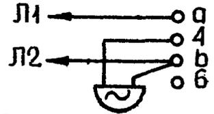
В розетке снять мостик 4-б или в вилке 4-5.
