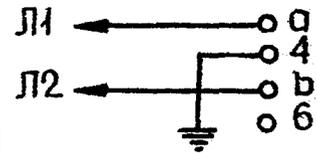
В розетке снять мостик 4-б или в вилке 4-5.
