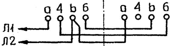
В добавочном аппарате снять мостик 6-7, а б в главном 4-б.
